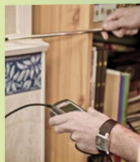
Recherche de fuite à l'aide d'un thermo-anémomètre
